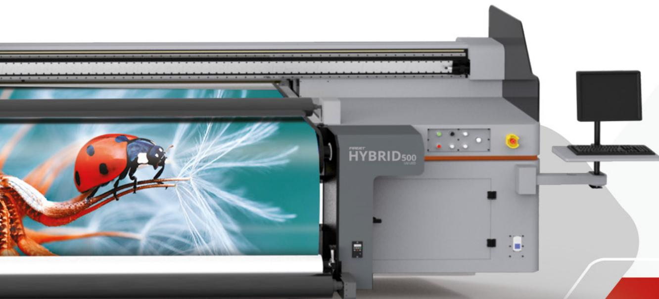
Impressora Industrial **HÍBRIDA UV LED**, para impressão de **MÍDIAS RÍGIDAS** e **FLEXÍVEIS**, com **largura de impressão de 5,00m** e altura de impressão de 25mm, equipada com cabeças industriais KM1024A/6pl a 28pl e disponível na configuração de **cores CMYK e Branco**.
